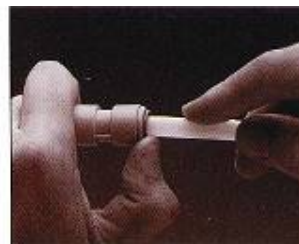
3. Skjut tillbaka hylsan för att ta bort slangens.
